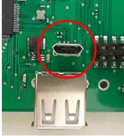
左写真のUSBコネクタ (USB Micro-B) と Windows パソコンを USB ケーブルで接続してください。下記のデバイスドライバが自動で起動します。電源は入れたままで構いません。
